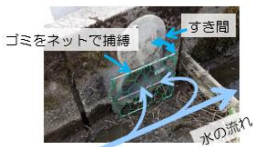
カバー無の給水 (水圧実験時、水頭差1.2m 開度 100%)
