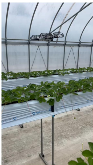
図 1-1 ドローンによる受粉と風力の測定
