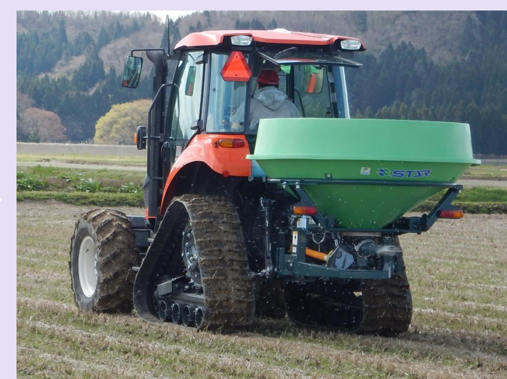
④生育マップ（左上）、収量コンバインと収量マップ（左下）、可変施肥ブロードキャスタ（右）
