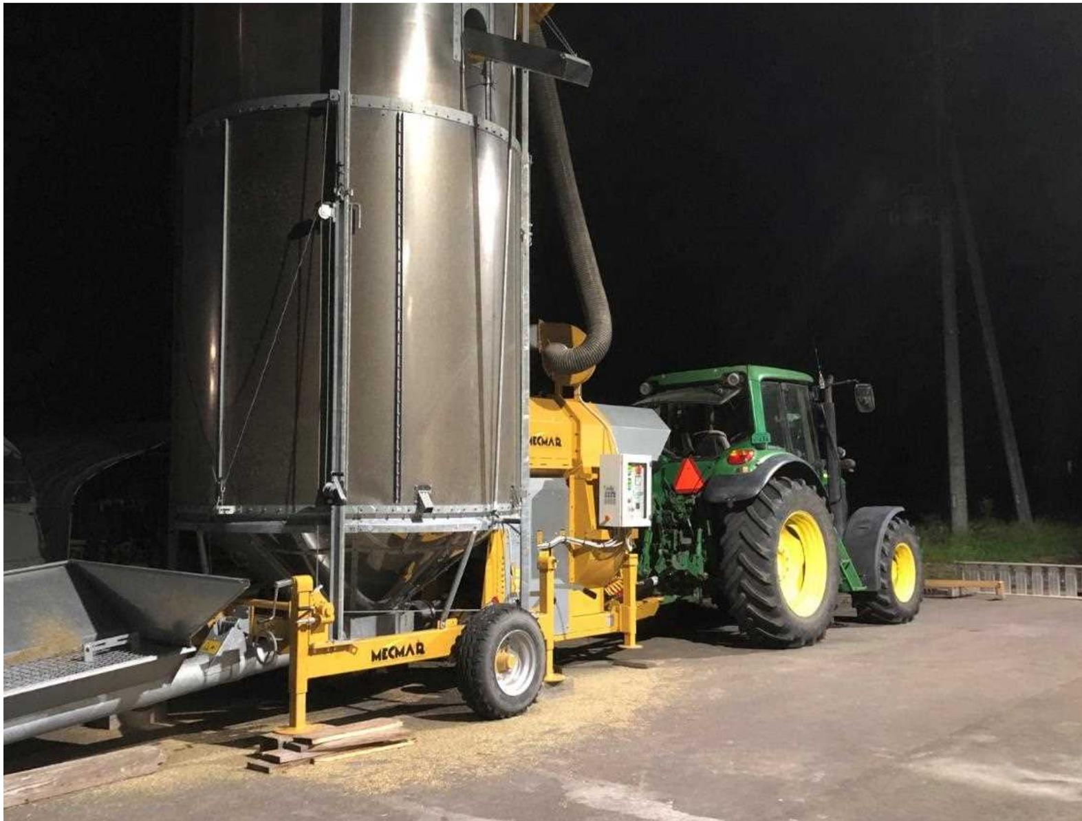
トラクター動力を利用した屋外移動用乾燥機 能力13トン
