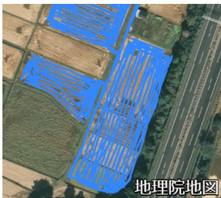
自作ロガーによるトラクタの軌跡
