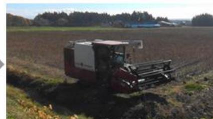
収量計測コンバインによる収穫
